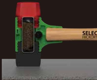
●鉄球が移動することで打撃力を上げると同時に、衝撃を吸収します。
